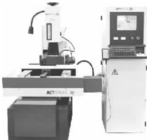
图 1-1 高速走丝电火花线切割机床
