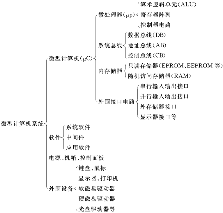
图 1.3 微处理器、微型计算机和微型计算机系统的关系
