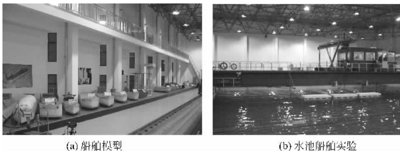
图 1-11 水池船舶实验与船舶模型
