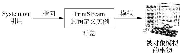
图 1.1 一个引用的例子。这里 System.out 引用一个预定义的 PrintStream 对象,以模拟一个监视器
