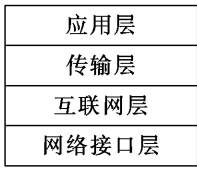
图 1.1 TCP/IP 协议参考模型
