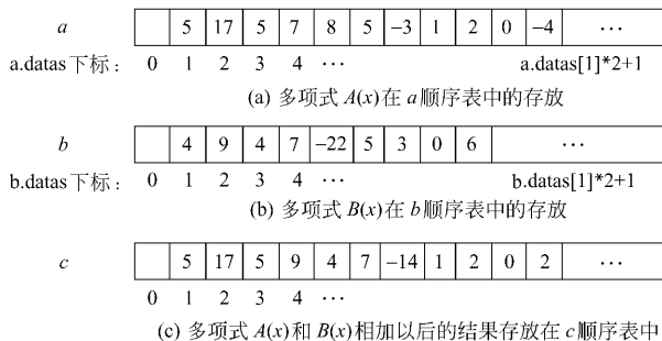
图 2.2 多项式相加结构示意图
