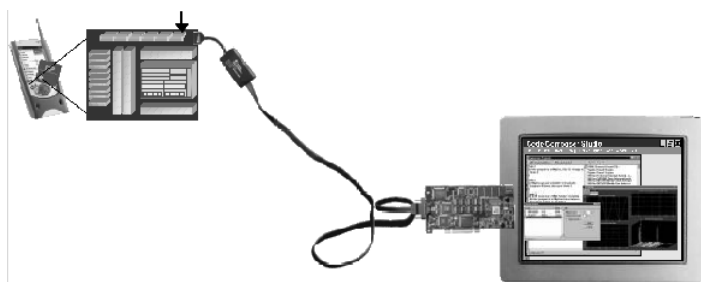
图 3-1 XDS560 硬件仿真体系的结构组成
