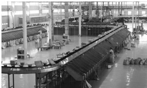
图 1-17 自动化分拣设备的实物图
