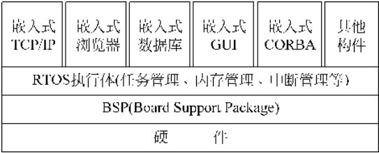
图 3-1 RTOS 的微内核结构
