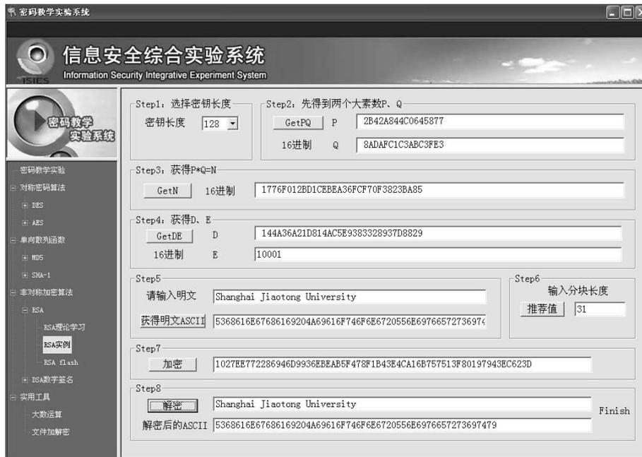
图 1.10 RSA 算法实验
