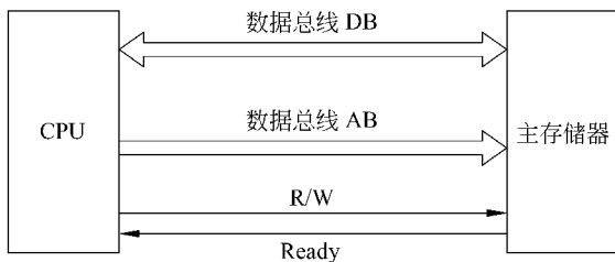
图 3.12 主存储器与 CPU 的连接
