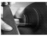
注意右手在前,左手在后,身体离开卡盘;禁止用砂布裹在工件上抛光,应比照用锉刀的方法,成直条状压在工件上 |
