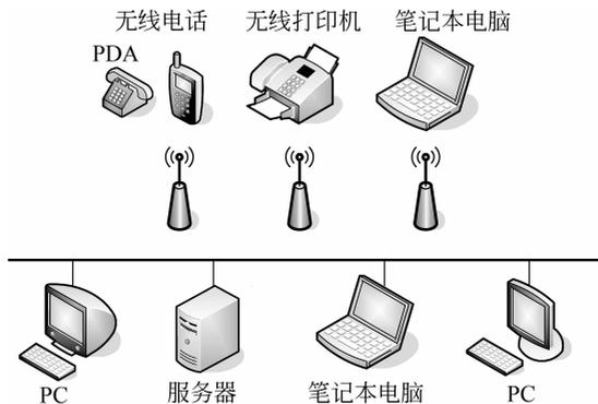
图 3.1 典型 WLAN 和 LAN 集成部署示意图
