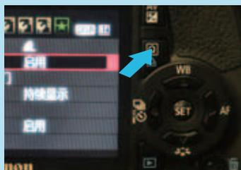
在显示拍摄设置时，按下 $\text{AF-ON}$ 按钮，出现速控屏幕。
