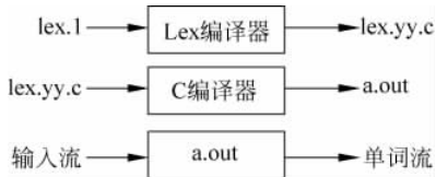
图 3-17 用 Lex 生成一个词法分析器
