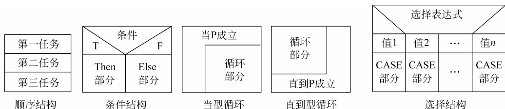
图 1-7 NS 图的几种标准控制结构
