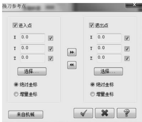
图 5-8 “换刀参考点”对话框
