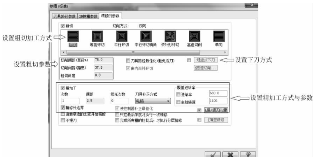
图 5-49 “粗切/精修的参数”对话框
