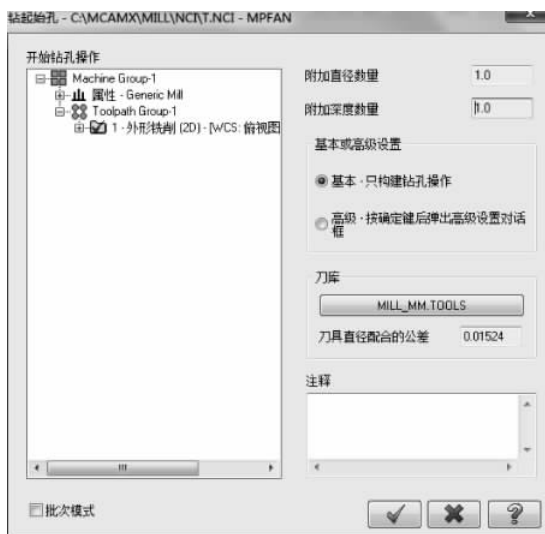
图 5-160 起始孔加工参数设置
