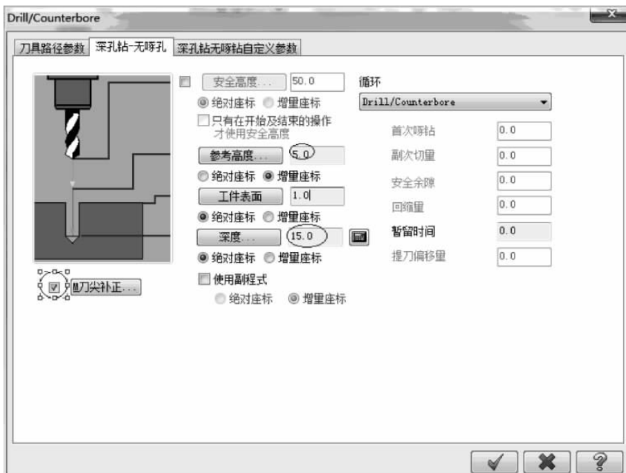
图 5-142 设置外形加工参数
