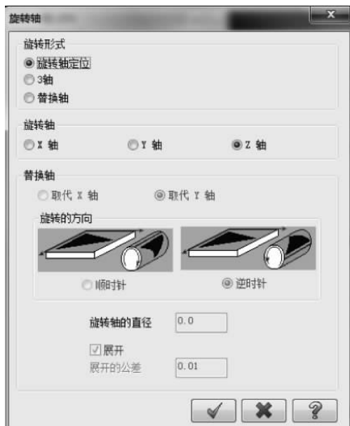
图 5-10 “旋转轴的设定”对话框
