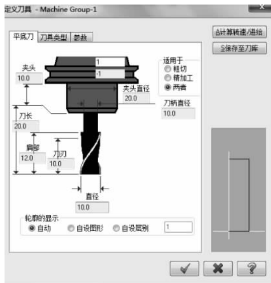
图 5-15 面铣刀参数设置选项卡
