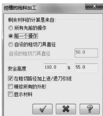
图 5-38 挖槽的残料加工对话框
