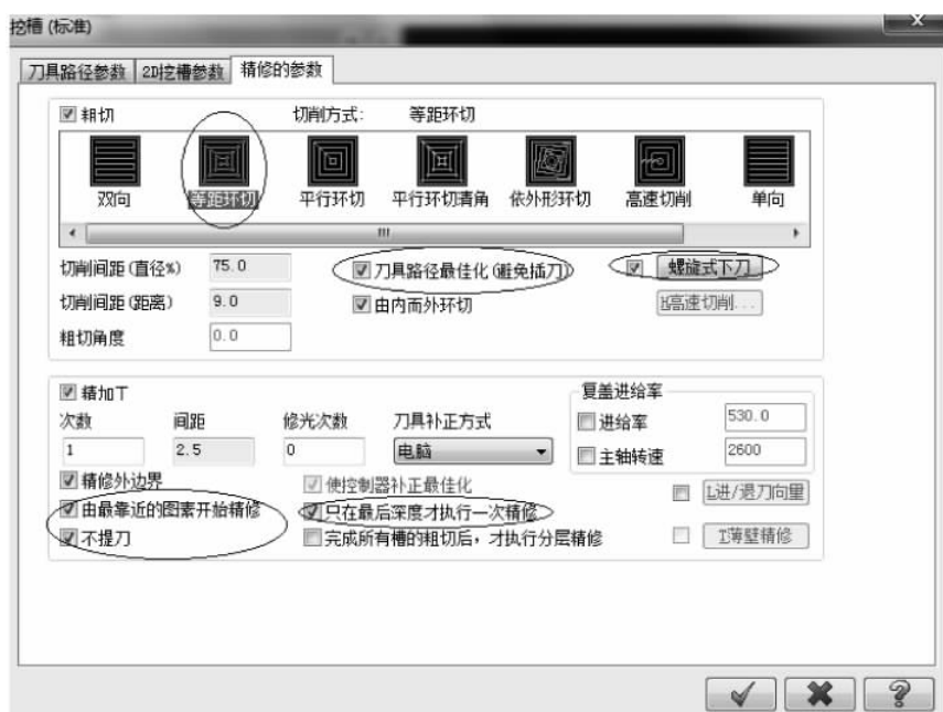
图 5-63 设置粗切/精修的参数
