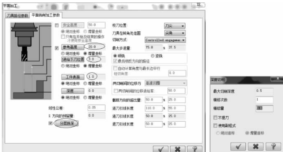
图 5-25 设置平面铣削参数
