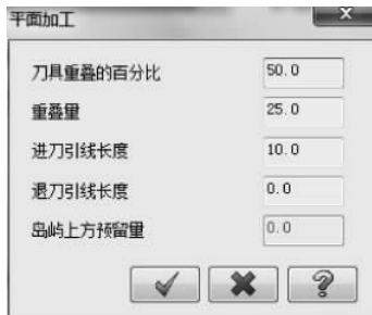
图 5-33 平面加工参数
