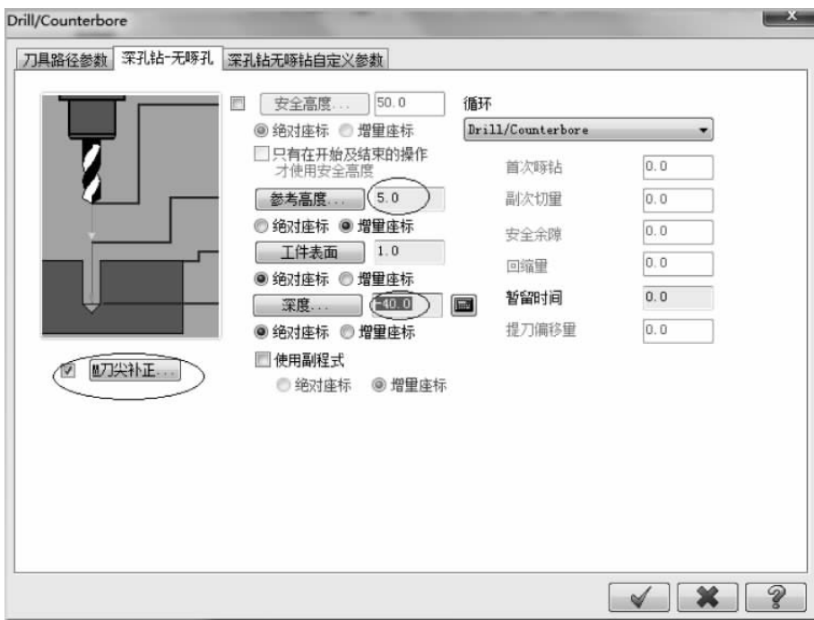
图 5-146 设置铰孔加工参数
