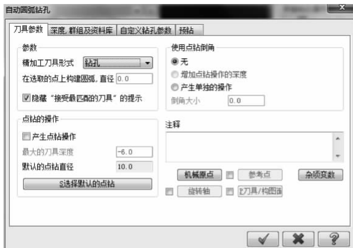
图 5-161 自动圆弧钻孔参数设置
