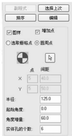
图 5-144 设置圆周阵列钻孔点参数
