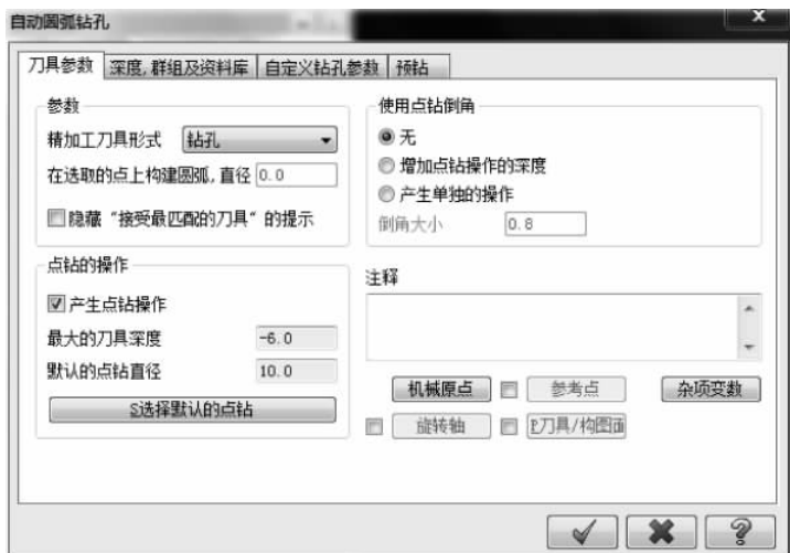
图 5-156 自动圆弧钻孔的“刀具参数”设置
