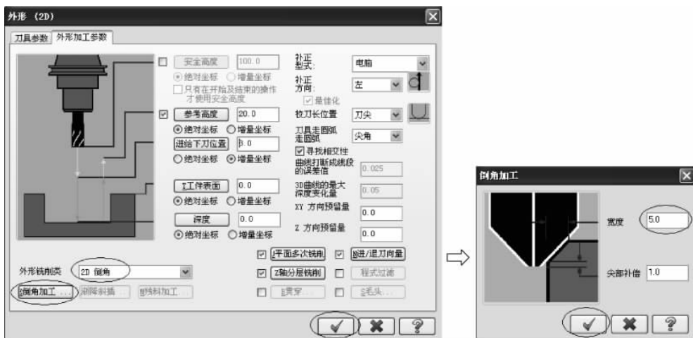
图 5-113 单击“倒角加工”按钮,弹出对话框
