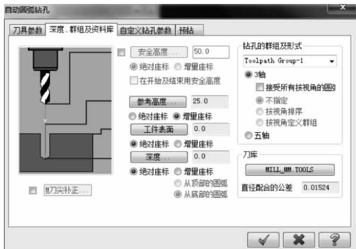
图 5-157 “自动圆弧钻孔”参数设置
