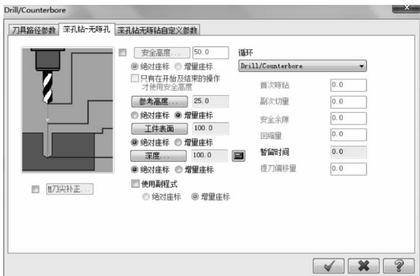
图 5-127 钻孔加工参数设置
