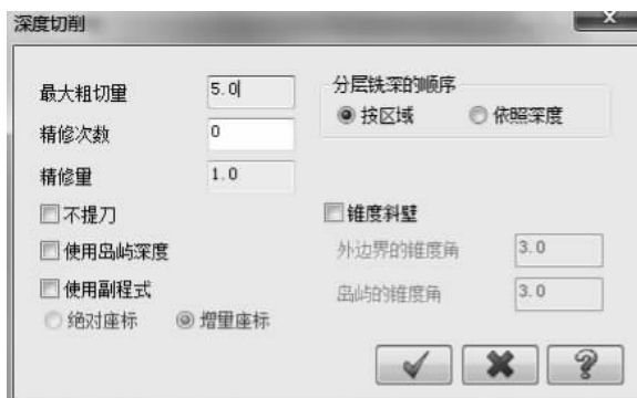
图 5-43 深度分层切削设置对话框
