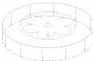
图 5-143 产生的钻孔刀具路径
