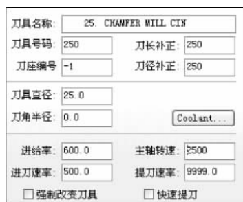
图 5-112 设置倒角铣刀参数
