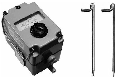
图 3-10 ZC-8 型接地电阻测量仪及其附件
