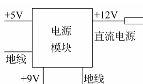
图 3-8 电源电路输出电压测量方法
