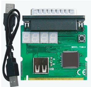
主板故障诊断卡
