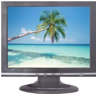
**显示器:** 显示器的外观与电视机很相似, 它是电脑最主要的输出设备, 主要用来显示电脑当前的工作状态及数据处理结果, 如系统界面、数据和输入的内容等。现在的电脑都采用液晶显示器, 具有辐射小、耗电量低、体积小等优点。
