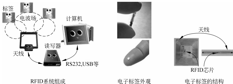
图 3.9 RFID 的系统组成
