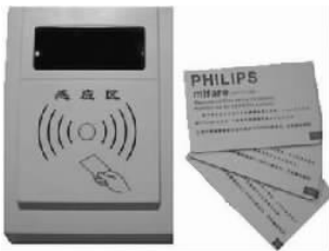
图 3.8 非接触式 IC 卡(射频卡) 存储信息,而磁卡是通过卡内的磁力记录信息。IC 卡的成
