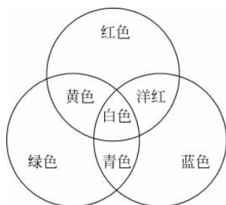
图 3.1 三基色相加混色原理
