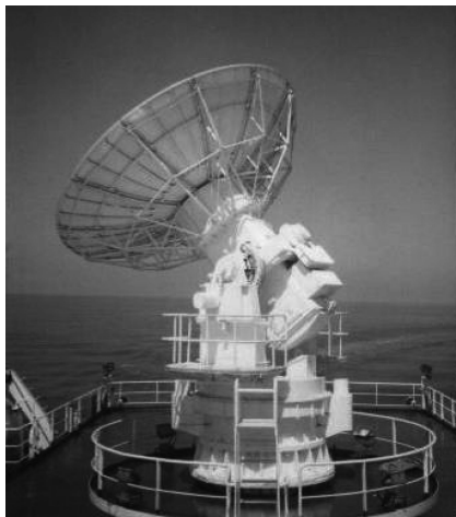
图 3.3 某远望号测量船卫通站天线
