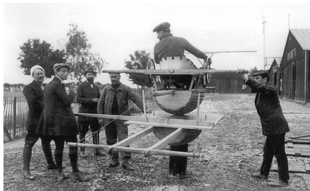
图 1-1 使用木桶、铁环与木头支架做成的飞行模拟器
