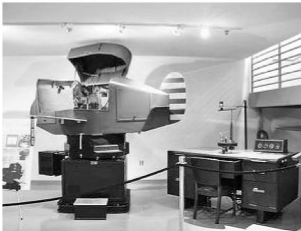
图 1-2 美国人林克研制的用于飞行员训练的“蓝盒子林克训练者号”飞行模拟器
