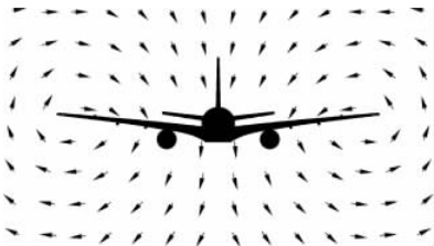
图 1.6 翼尖涡流示意图
