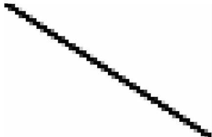
图 5-3 文字处理软件 Word 绘制的反走样直线段
