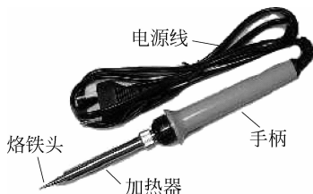
图 1-3 内热式电烙铁外形
