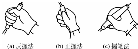
图 1-9 电烙铁的握持方法
