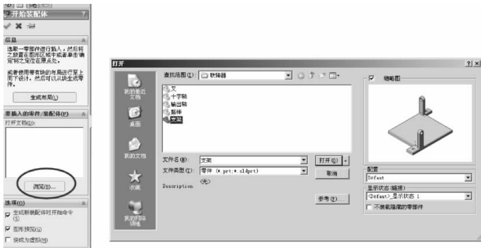
图 3-53 插入支架零件
