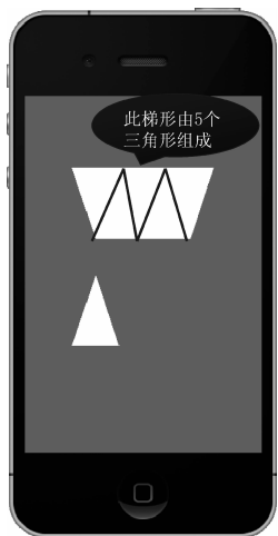
图 3.26 使用三角形条渲染梯形
