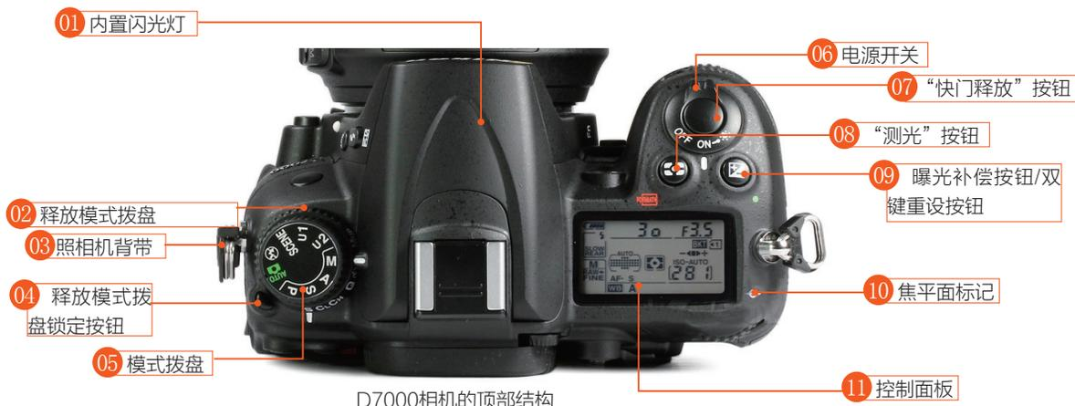
D7000相机的顶部结构
