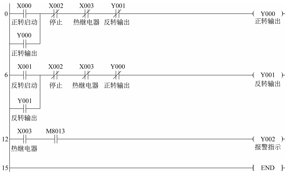
图 3-1-12 利用触点组合编写的控制梯形图
