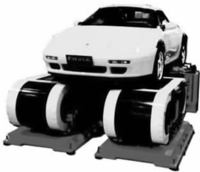
图 1-7 汽车底盘测功机的使用
