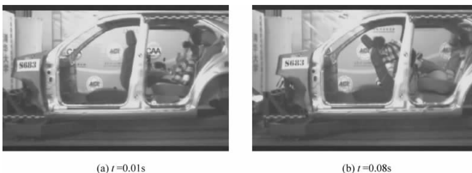
图 1-6 在 50km/h 下碰撞模拟试验儿童状态
