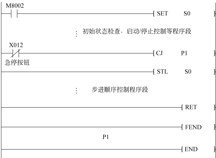
图 3-14 用条件跳转指令实现急停处理
