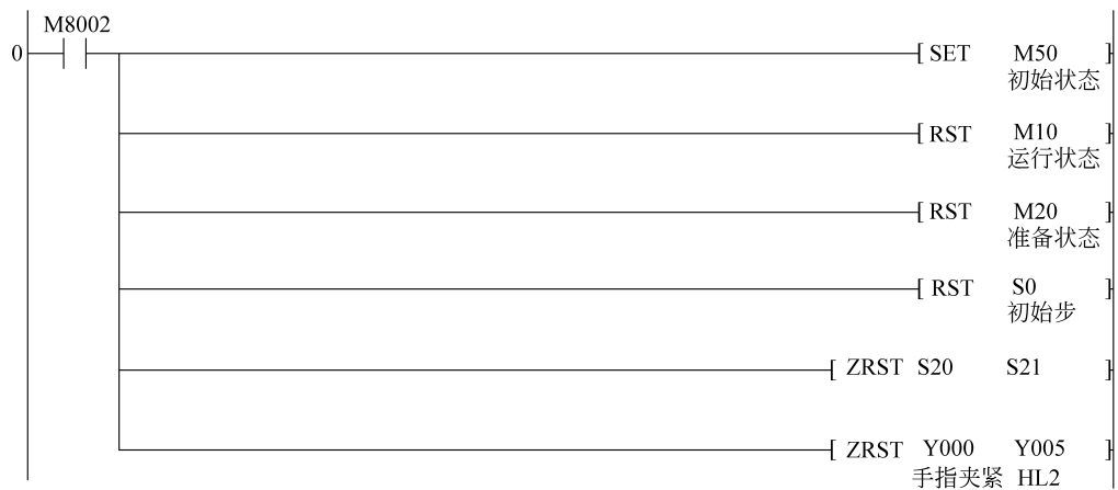
图 3-5 上电复位程序设计
