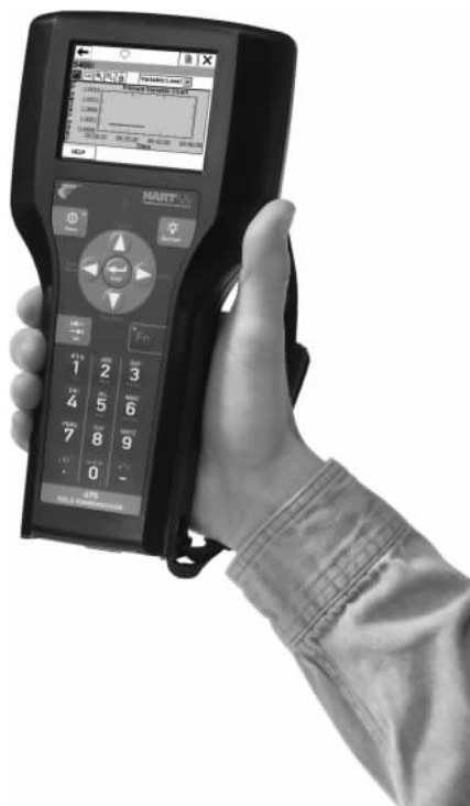
图 3-4 用于检查和设置变送器校准的手持设备
