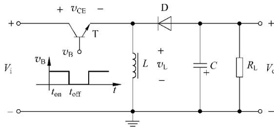
图 3.4-8 极性反转型 DC/DC 变换器原理电路
