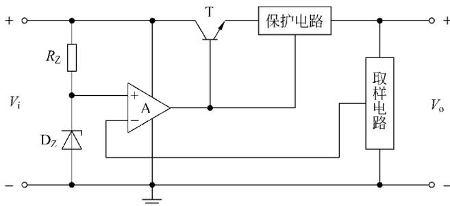
图 3.2-3 三端式固定式稳压器内部组成框图
