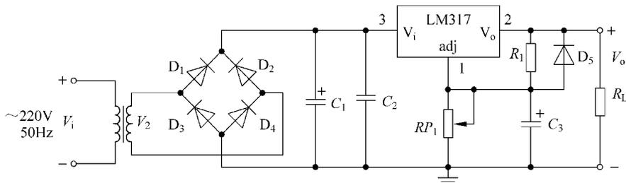
图 3.3-2 例 3.3-1 设计原理图
