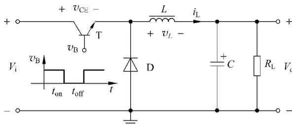
图 3.4-1 降压型 DC/DC 变换器原理电路
