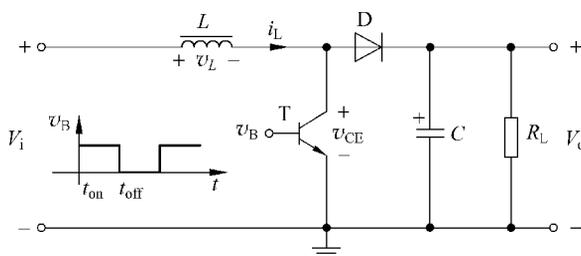
图 3.4-5 升压型 DC/DC 变换器原理电路
