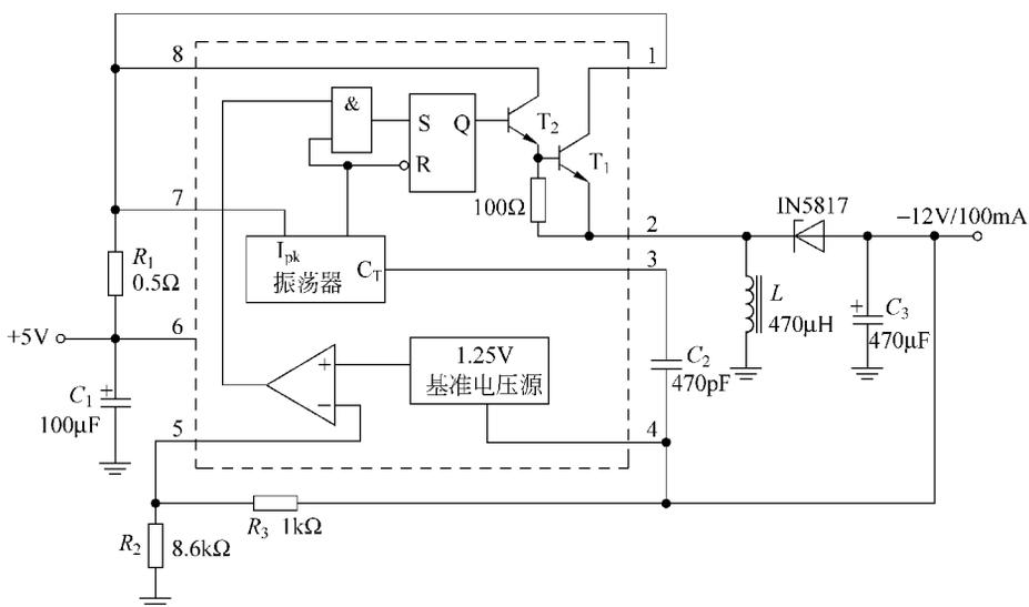
图 3.4-9 由 MC34063 构成的极性反转电路
