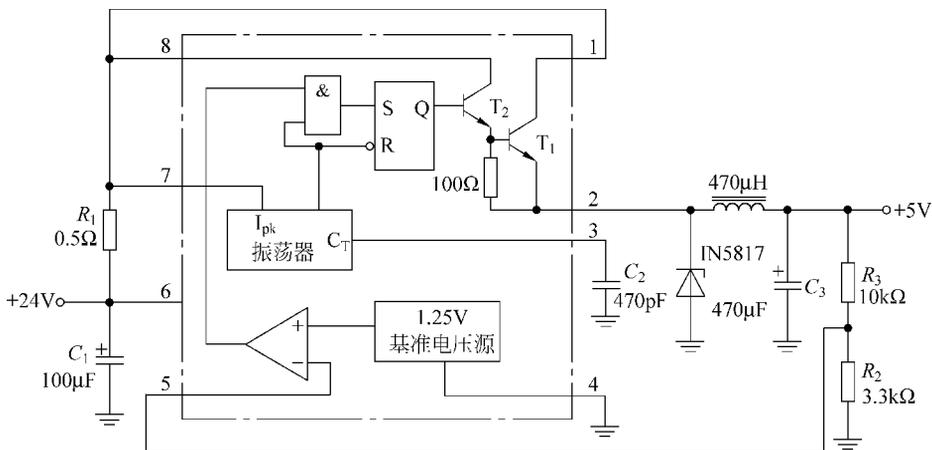
图 3.4-4 由 MC34063 构成的降压电路
