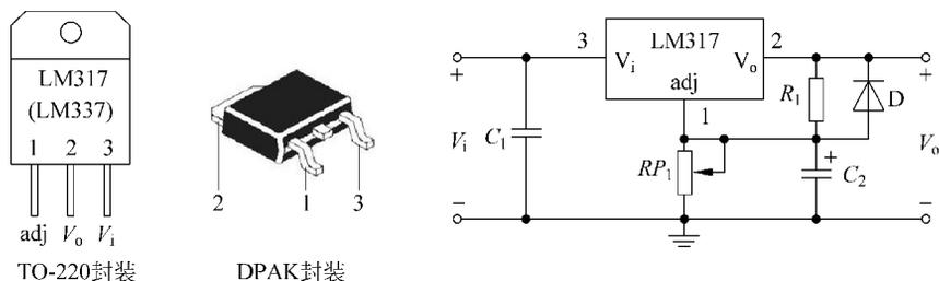
图 3.3-1 LM317 的引脚排列和典型连接图
