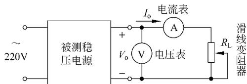
图 3.1-2  $I_{o\max}$  和  $V_o$  测量电路
