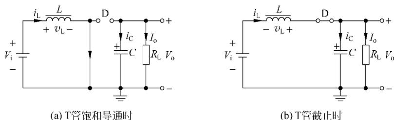
图 3.4-6 升压型 DC/DC 变换器等效电路
