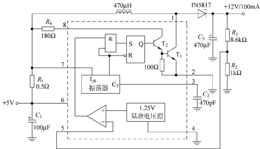
图 3.4-7 由 MC34063 构成的升压电路
