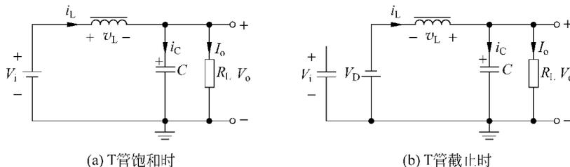
图 3.4-2 降压型 DC/DC 变换器等效电路
