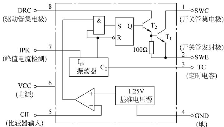
图 3.4-3 MC34063 引脚排列和原理框图
