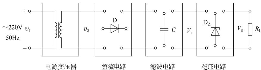
图 3.1-1 直流稳压电源的组成
