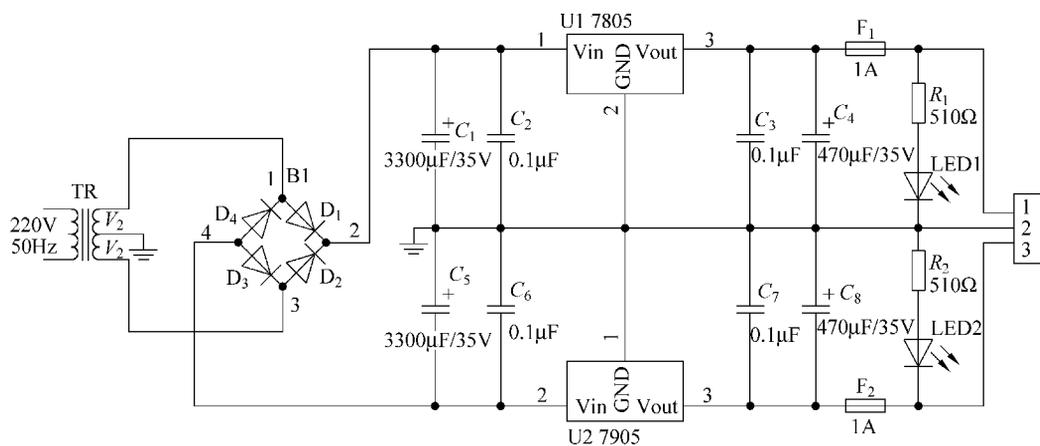
图 3.2-1  $\pm 5\text{V}$  的直流稳压电源的原理图
