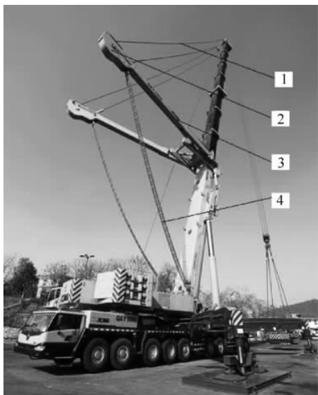
图 3-17 徐工 QAY1000 型全地面起重机主臂超起工况
