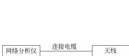
图 3-7 驻波系数测试连接图
