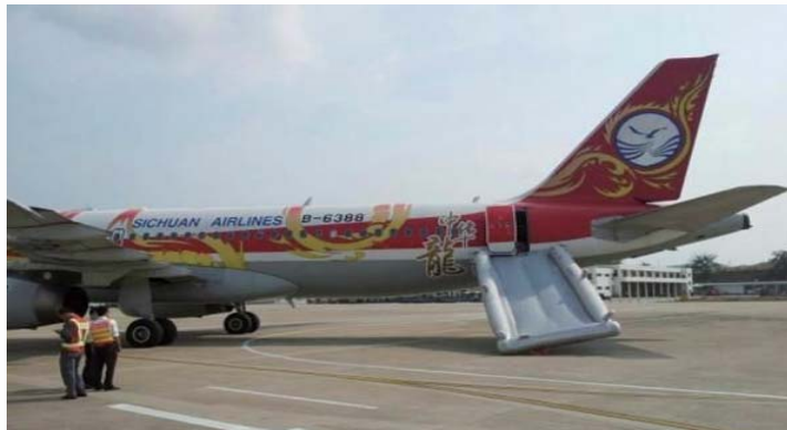
图 1-1 舱门应急滑梯在正常情况下被放出
