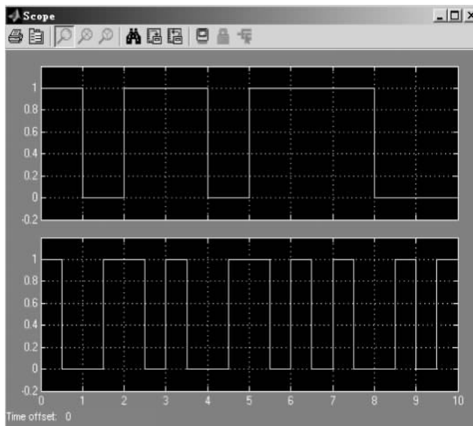
图 3-10 数字双相码的 Simulink 仿真结果
