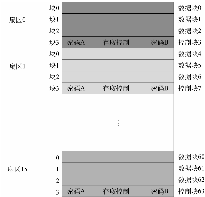
图 3.9 S50 卡存储结构
