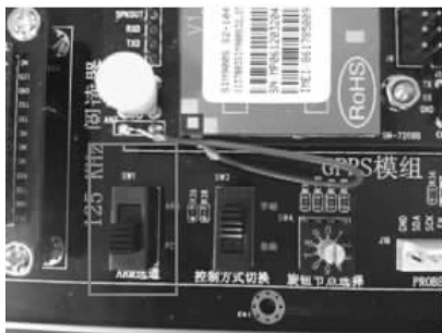
图 3.2 选择串口和计算机相连
