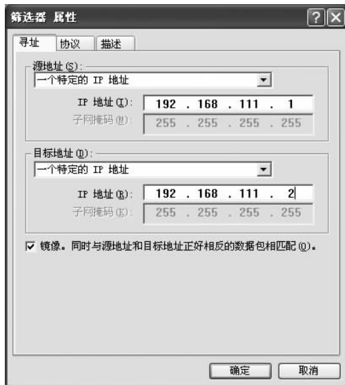
图 3-20 设置源和目的 IP 地址
