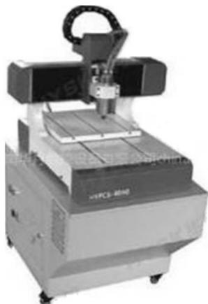
图 1-32 制造电路板的雕刻机
