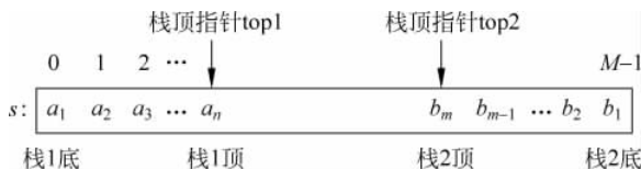
图 3.10 两个顺序栈的存储结构
