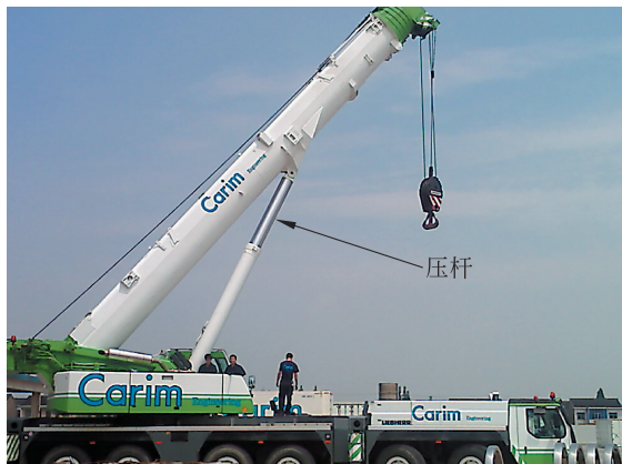
图 1-4 工程机械中的压杆
