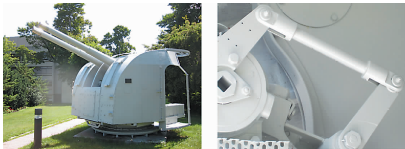
图 2-5 舰载火炮操纵机构中的拉压杆
