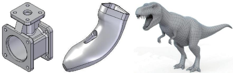
图 3-2 实体、曲面和多边形网格模型示例
