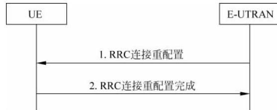
图 3-9 RRC 连接重配置流程
