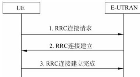
图 3-5 RRC 连接建立流程
