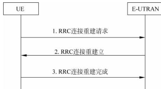
图3-7 RRC连接重建流程
