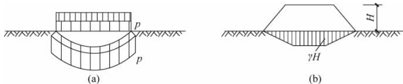
图 3-6 柔性基础下的压力分布
