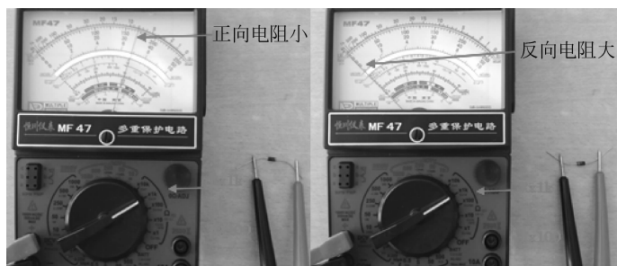
图 3-6 万用表检测二极管示意图
