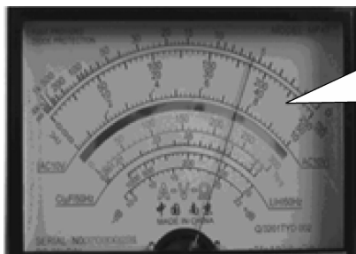
图 3-13 万用表测交流电压实例
